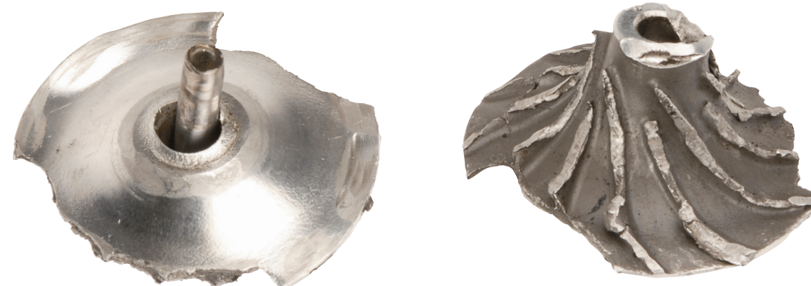
Rottura totale del componente
